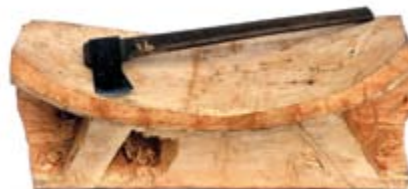
INÍCIO DO ENTALHE DA ESTRUTURA DE APOIO DO BANCO
