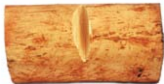
PRIMEIRO CORTE NA MADEIRA, TALHO NO CENTRO DO QUE SERÁ O ASSENTO
