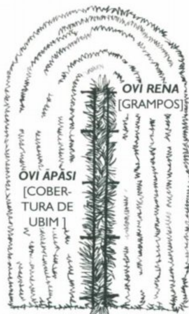
Cobertura pronta com acabamentos da cumeeira.
