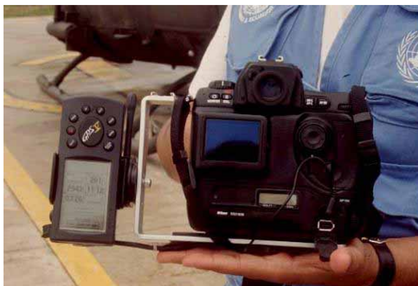
Cámara digital con unidad de GPS
