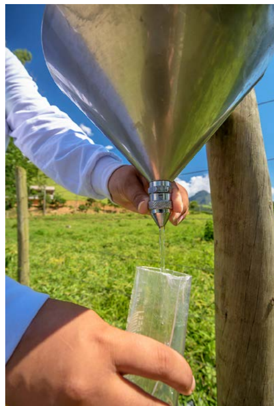
Foto 27: Medição do pluviômetro. Foto: Marcos Amend.
