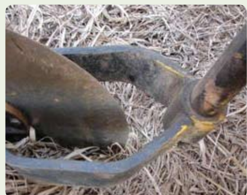
Figura 30 - Uso de um pedaço de madeira com uma corrente em sua extremidade para a orientação da subsolagem em relação à linha adjacente (A) e disco de corte do subsolador cortando a palhada já seca (B).
