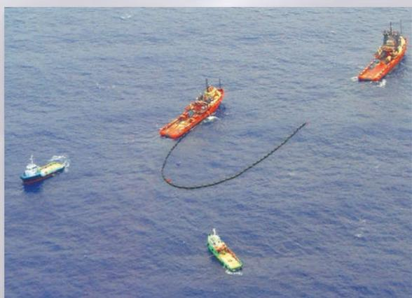
para cercar o petróleo derramado) e equipamentos que removem este óleo do mar e o envia para os tanques dos barcos de apoio.
