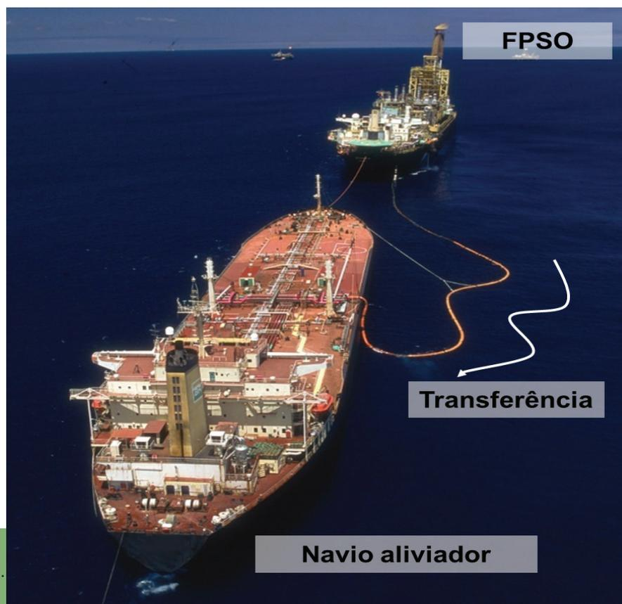
**Figura 10** – Esquema de transferência de óleo (*offloading*).
