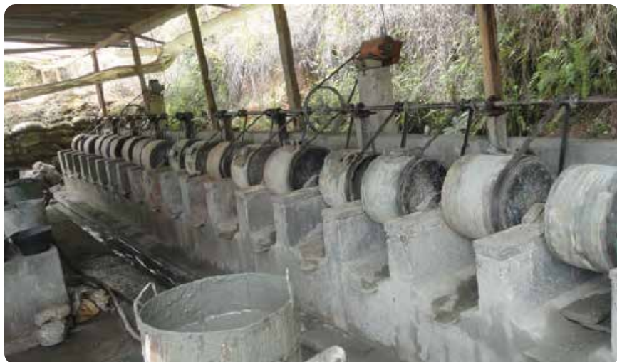
Figura 11. Moinhos de bola na região de Íquira conhecidos como 'cocos'. Fonte: Serviço Geológico Colombiano
