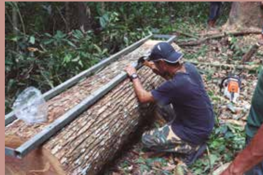
Figura 3 – Colocação de um quadro de alumínio plano, com auxílio de alguns pregos ao seu redor, para ser utilizado como referência para a primeira tábua ser retirada
