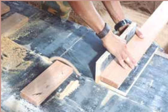
Figura 9 – Corte das peças de 16 e 21 cm de comprimento a partir das pranchas de 8 cm de largura por 2,5 cm de espessura.
