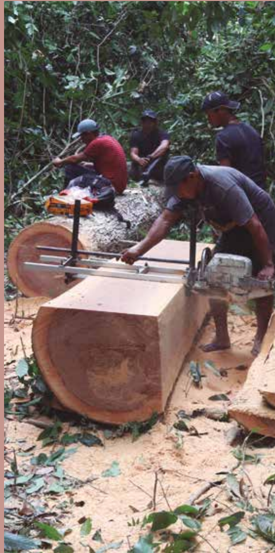
Figura 6 – A retirada de tábuas fica mais fácil quando a tora recebe o devido tratamento. O manejo da guia para a motosserra pode ser feito por apenas uma pessoa (acima), mas é recomendado que ao menos duas pessoas façam este trabalho, para momentos como o transporte das tábuas (ao lado).
