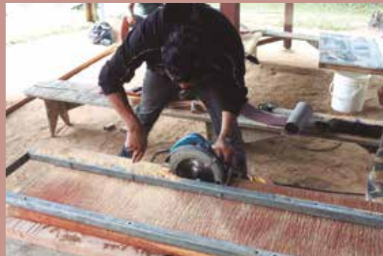
Figura 7 – Corte das pranchas de 8 cm de largura a partir das tábuas já secas, utilizando-se a serra circular manualmente. Importante usar gabaritos para um corte mais preciso.
