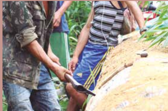
Figura 3 – Um machado é indispensável para uma boa abertura da janela. Às vezes é preciso fazer uma alavanca e quebrar pequenos pedaços de madeira que não foram cortados pela motosserra
