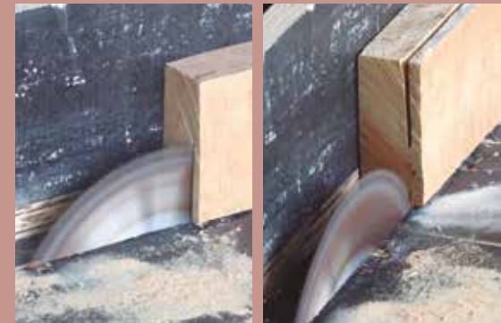
Figura 8 – Processo de aplainamento das pranchas utilizando-se uma serra circular de bancada. Uma alternativa mais fácil, porém mais custosa e desafiadora em certos contextos, é utilizar uma plaina desengrossadeira.
