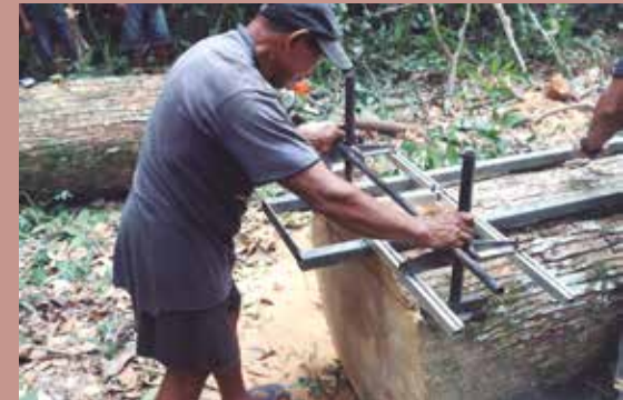
Figura 4 – Corte da primeira tábua utilizando-se o quadro instalado como referência. Essa tábua será descartada por ter um dos lados curvos.
