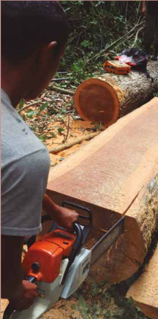
Figura 5 – Retirada de uma das laterais da tora com o objetivo de facilitar os próximos cortes.
