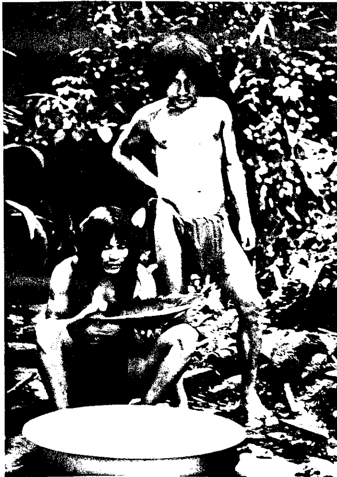
Figura 3 - Apuração do ouro sem o uso de mercúrio. O pré-concentrado da caixa é concentrado na bateia usando-se a lacia para evitar perdas. O concentrado final é seco e apurado por sopro.
