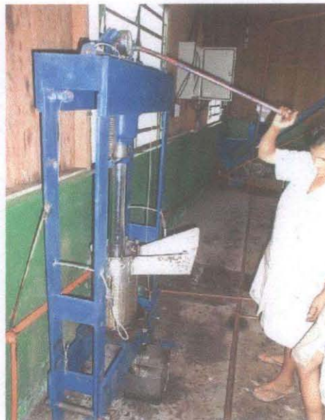
Foto 35: pressagem da torta de filtro na prensa hidráulica manual para extrair o óleo residual.
