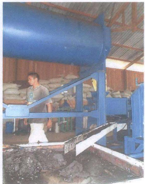
Foto 33 : durante a pressagem : o óleo que sai é preto, e sofre uma primeira filtragem por gravidade antes de correr na primeira cuva
