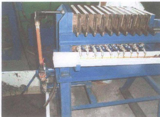
Foto 34 : o óleo é bombeado na primeira cuva até as placas do filtro-prensa (aqui, no segundo conjunto de produção).
