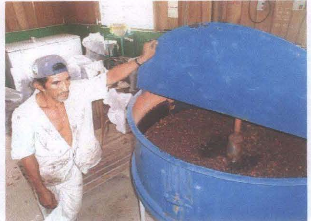
Foto 31 : experiência de aquecimento das sementes trituradas no tacho-cozedor do primeiro conjunto de produção
