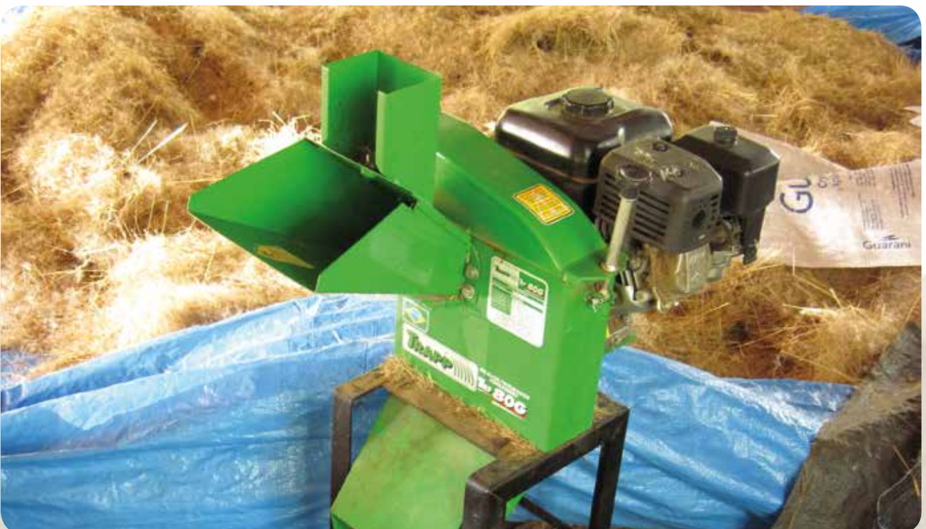
Ensiladeira de forragem para trituração dos pendões de capins e frutos secos. Secagem das sementes a sombra.
