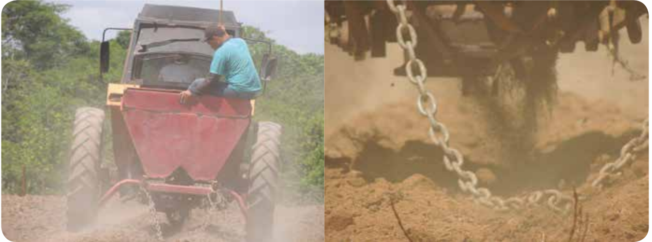
Semeadura em linha sendo realizada com calcareadora adaptada. Detalhe para a saída das sementes da calcareadora sem o espalhador e com uma corrente para enterrar as sementes.
