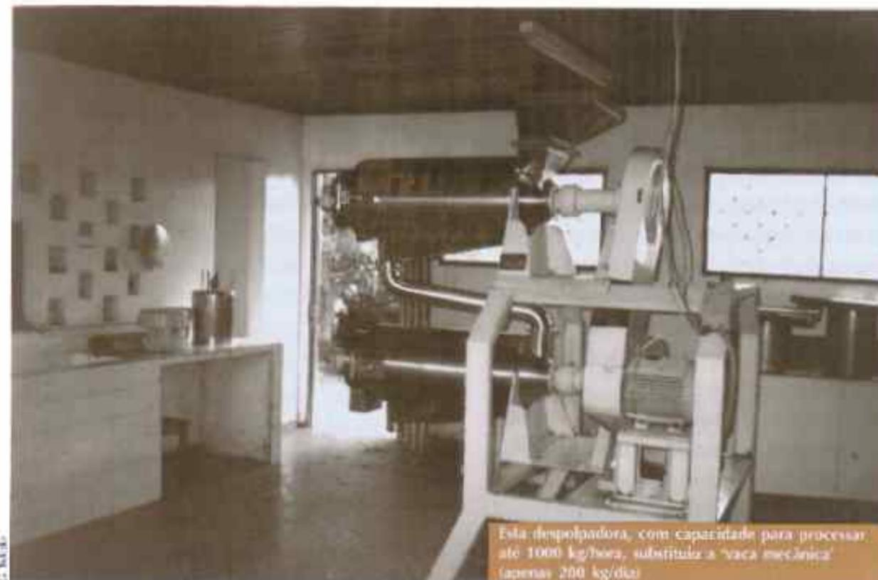
Esta despolpadora, com capacidade para processar até 1000 kg/hora, substituiu a 'vaca mecânica' (apenas 200 kg/dia)
