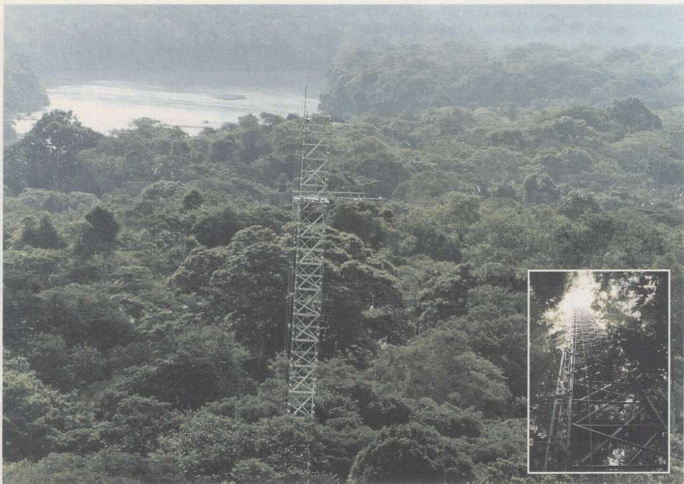
TORRES METÁLICAS assomam sobre a superfície das árvores, formando plataforma de coleta de dados para estudos da complexa dinâmica da floresta
